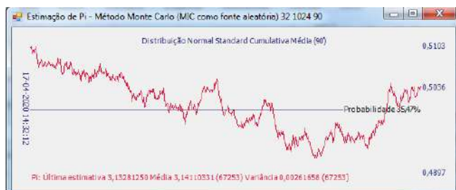
Figura 9 – Interface gráfica real desenvolvida para o mecanismo descrito. Após cerca de 67k ciclos a estimação para \pi apresenta os 4 dígitos mais significativos corretos
