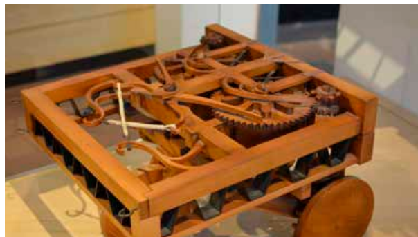
Model samohodnog vozila izrađen prema Atlantskom kodeksu, list 812, Ambrozijanska knjižnica, Milano.
